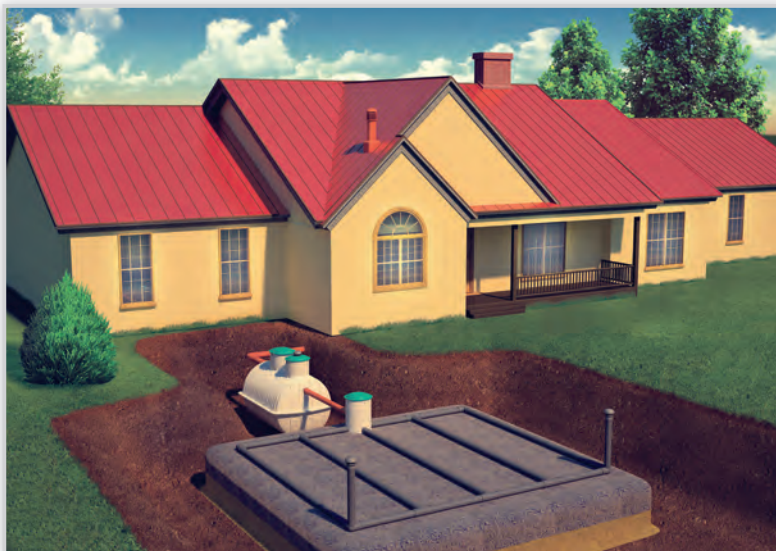
Klasyczna oczyszczalnia ekologiczna. Osadnik gnilny z odbiornikiem gruntowym (poprzez drenaż). Znakomita alternatywa wobec szamba dla dobrze przepuszczalnych gruntów i niskiego poziomu wód gruntowych. Sprawdza się również w domkach letniskowych (obiektach używanych okresowo, sezonowo). Wymaga wprawdzie około 50 m 2 powierzchni ale do pracy nie potrzebuje prądu i prawidłowo eksploatowana zapewni satysfakcję przez kilka dekad.
